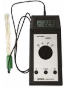
**MEDIDOR DE PH/ CONDUCTIVIDAD/ TEMPERATURA PORTÁTIL**
