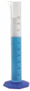
**PROBETA DE VIDRIO Y BASE DE PLÁSTICO**
