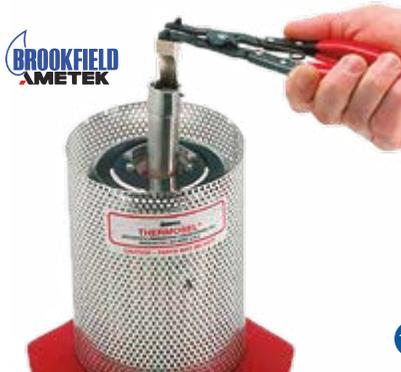
**PINZA DE EXTRACCIÓN PARA VISCOSÍMETRO**
