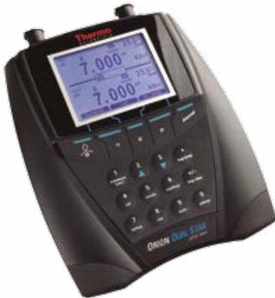
**MEDIDOR VERSA STAR PARA PH/ ISE/ CONDUCTIVIDAD/ SDT/ RESISTIVIDAD/ BDO/ OXÍGENO DISUELT/ TEMPERATURA DE MESA**
