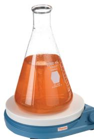
Placa circular de silicón. Carcasa de polipropileno.
